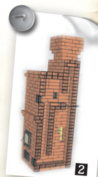
1. Внешний вид колпаковой печи 2. 3D проект печи
